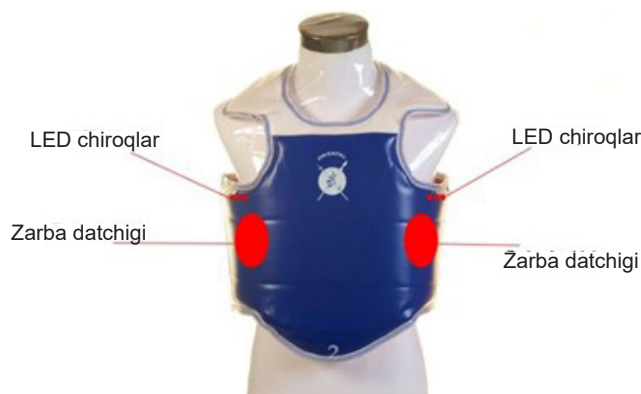
1-rasm: LED-signal va zarba datchiklari asosida javob harakatini qayd etuvchi qurilma sxemasi.
